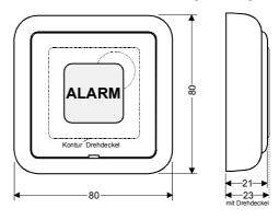
Bei der Abdeckung mit Drehdeckel, ist die Drehlagerung des Schwenkdeckels nur für eine geringe Anzahl an Drehbewegungen ausgelegt!
